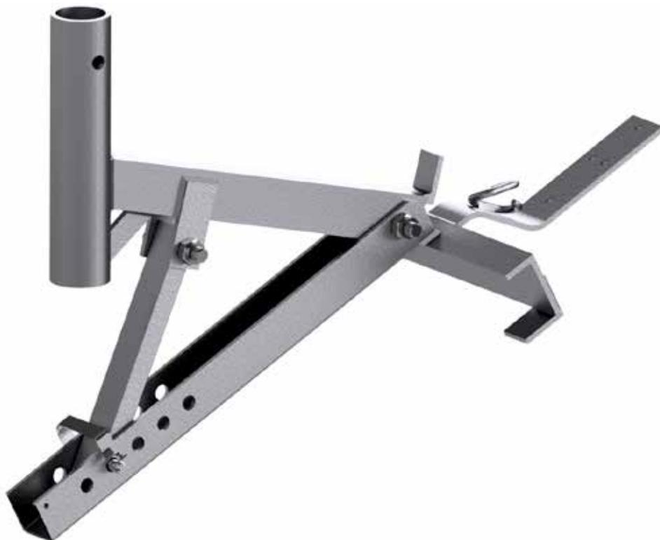
Mit der **Absturzsicherung Solartec Plus** kann ein um 20° bis 60° geneigtes Holzdach schnell und einfach gesichert werden. Auf der Absturzsicherung Solartec Plus kann eine Holzbohle mit einer maximalen Breite von 32 cm gelegt werden, die als gerade Ablagefläche dienen kann. Dank des geringen Platzbedarfs kann es für alle Renovierungsarbeiten verwendet werden:
