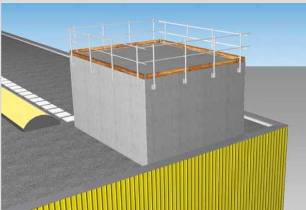
Permanenter Seitenschutz am Gebäude verankert, Oblicht dauerhaft durchbruchssicher
