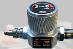
Dieser Druckminderer/Reduzierventil wird an Ihrem pneumatischen Gerät befestigt. Trotz unterschiedlicher Drücke auf der Eingangsseite (Eingangsdruck) sorgt er dafür, dass auf der Ausgangsseite ein bestimmter Ausgangsdruck nicht überschritten wird. Betriebsdruck 24 bar --> 3 bis 8 bar
