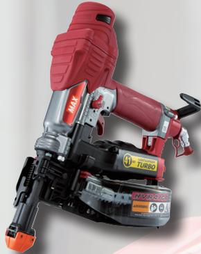
Der HVR41-G4 ist ein Hochdruckschrauber, bei dem das Einschlagen und Schrauben kombiniert wird, was das Verschrauben schneller macht. Es ist für Schrauben von Gipskarton auf Metall- und Holzständerwerk geeignet. Zusätzlich gibt es den "Schrägschraub-Modus", das ein Schrauben in einem Winkel ermöglicht.
